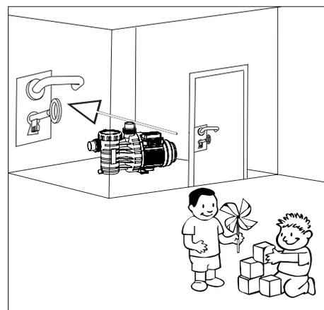
Achten Sie auf die Eigenbelüftung des Motors. Der Aufstellungs-ort der Pumpe muss trocken und gut belüftet sein. Bitte keinerlei Fremdkörper in unmittelbarer Nähe der Pumpe aufstellen.
